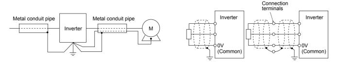
Fig. 8 Grounding of metal conduit pipe
